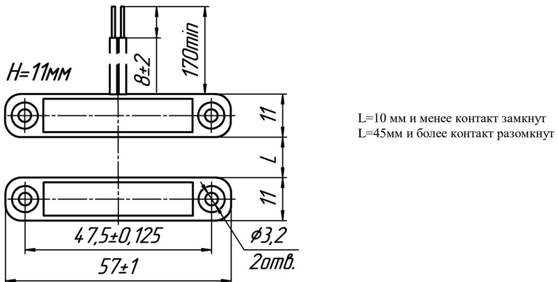
Рис.1. Габаритные и присоединительные размеры извещателя
